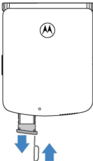
3. Setzen Sie die Karte ein (Goldkontakte nach unten) oder entfernen Sie sie.
