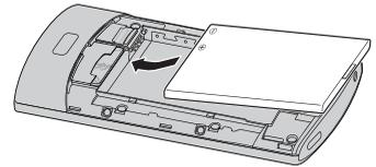
Richten Sie die Zungen auf dem Akkudeckel am Fach aus und schieben Sie den Deckel an seine Position, bis er einrastet.
