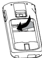
Setzen Sie den Akku ein. Die goldenen Kontakte des Akkus zeigen dabei nach oben links. Drücken Sie leicht auf das untere Ende des Akkus, bis dieser einrastet.
