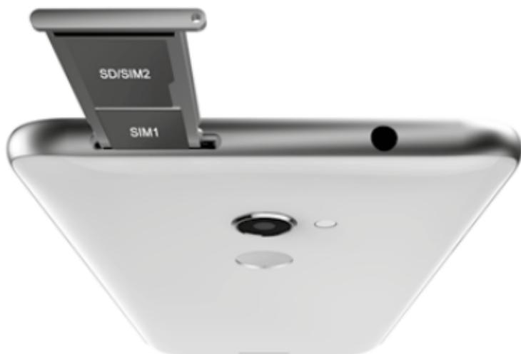
2. Ziehen Sie den Kartenschacht vorsichtig heraus. Bitte eine Micro SIM-Karte in Steckplatz 1 einsetzen, und eine Nano SIM- oder Micro SD (T-Flash)-Karte in Steckplatz 2.
