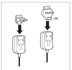
Schieben Sie den geeigneten Netzadapterstecker in Pfeilrichtung in den Netzadapter, bis er einrastet.
