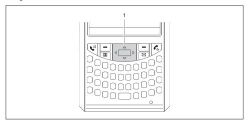
Die Funktionsweise des Navigationskreuzes (1) ist abhängig von der Applikation, in der Sie sich befinden. In einigen Applikationen scrollen Sie innerhalb eines Menüs zeilenweise nach oben, unten, links oder rechts. Menü-Einträge aktivieren Sie durch Druck auf die Mitte des Navigationskreuzes. In anderen Applikationen, wie z. B. E-Mail, scrollen Sie mit dem Navigationskreuz dagegen Seite für Seite nach oben oder unten.
