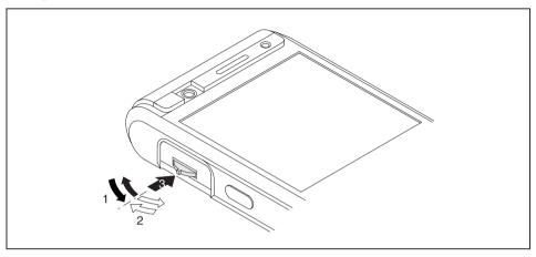
Mit der Scroll-Taste scrollen Sie innerhalb des Menüs oder einer Applikation nach oben oder nach unten, vor und zurück (1, 2). Durch Druck auf die Scroll-Taste in der mittleren Position aktivieren Sie Menü-Einträge (3).
