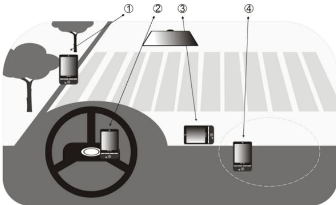
1. Bringen Sie das Gerät nicht an einem Ort an, an dem es die Sicht des Fahrers versperrt.
