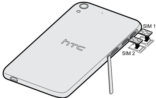
5. Stellen Sie beim Wiedereinsetzen der nano SIM-Kartenfächer sicher, dass sie nach oben zeigen, so dass die nano SIM-Karten nicht herausfallen können. Schieben Sie die Fächer vollständig in die Einschübe.
