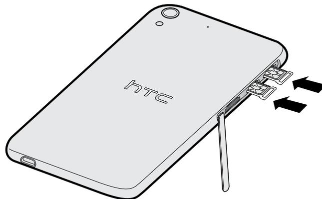
6. Um den Einschub zu schließen, schieben Sie den Plastikhebel in die Seite und drücken Sie auf die Abdeckung, bis sie einrastet.
