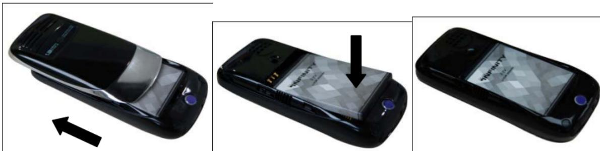
Hinweis: *Bitte halten Sie sich an die schematische Darstellung, so dass die Kontakte des Akkus keinen Schaden nehmen.*
