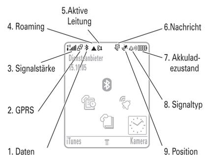
**1 Datenanzeige** - Zeigt den Verbindungsstatus. Das Bluetooth®-Symbol wird angezeigt, wenn das Telefon mit einem anderen Gerät gekoppelt ist. Andere Anzeigen:
