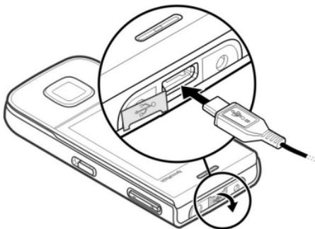
Öffnen Sie die Abdeckung des USB-Anschlusses, und schließen Sie das USB-Kabel an das Gerät an.
