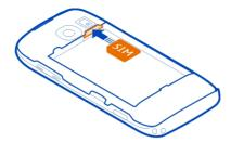
5 Beachten Sie die Anschlusskontakte des Akkus, setzen Sie den Akku ein und bringen Sie die rückseitige Abdeckung wieder an.
