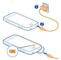
**Tipp:** Wenn keine Steckdose verfügbar ist, können Sie auch über den USB-Anschluss aufladen. Schließen Sie Ihr Mobiltelefon über ein USB-Datenkabel an ein anderes kompatibles Gerät an, zum Beispiel an einen Computer. Während des Aufladevorgangs können Daten kopiert werden.
