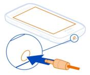
Schließen Sie keine Produkte an, die ein Ausgangssignal erzeugen, da das Gerät dadurch beschädigt werden kann. Schließen Sie keine Spannungsquelle an den Nokia AV-Anschluss an. Achten Sie besonders auf die Einstellung der Lautstärke, wenn Sie ein externes Gerät oder Headset, das nicht von Nokia für die Verwendung mit diesem Gerät zugelassen wurde, an den Nokia AV-Anschluss anschließen.
