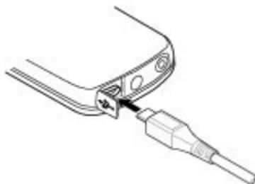
Öffnen Sie die Abdeckung des USB-Anschlusses, und schließen Sie das USB-Kabel an das Gerät an.
