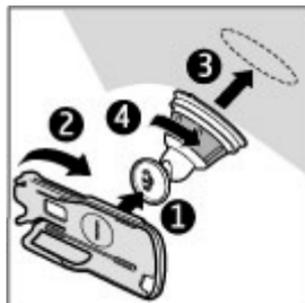
Zum Abnehmen des Gerätehalters von der Befestigungsvorrichtung drehen Sie den Gerätehalter gegen den Uhrzeigersinn.
