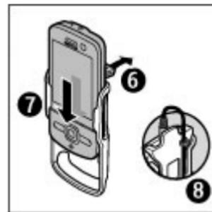
Verwenden Sie zum Aufladen des Akkus Ihres mobilen Geräts ein kompatibles Ladegerät. Zum Anbringen des Ladegerätkabels an der Rückseite des Gerätehalters führen Sie das Kabel durch den Schlitz in die Kabelhalterung. Schließen Sie den Stecker des Ladegeräts dann an den Ladegerätsanschluss oben am mobilen Gerät an.
