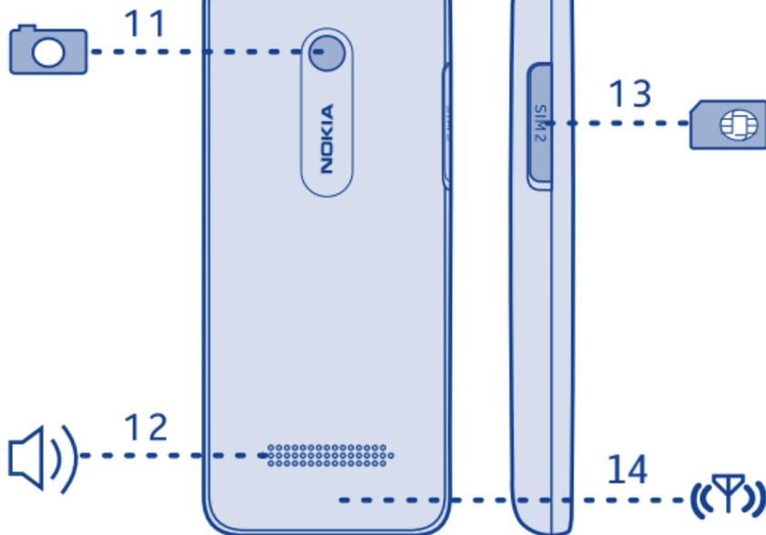
11 Kameraobjektiv. Entfernen Sie vor Verwendung der Kamera die Schutzfolie von der Linse.
