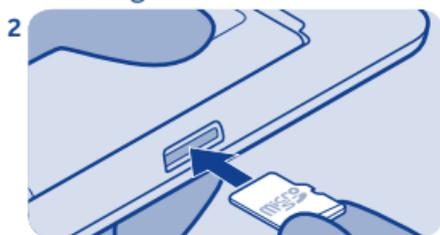
Schieben Sie die Speicherkarte ein, bis sie einrastet. Der Kontaktbereich muss nach unten zeigen.
