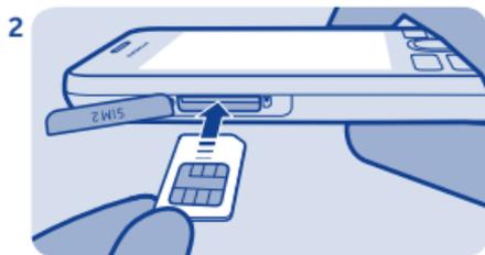
Setzen Sie die SIM-Karte mit der Kontaktfläche nach oben weisend ein.
