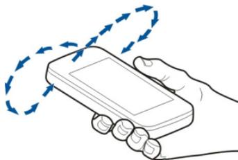
Der Kompass verfügt nur über eine begrenzte Genauigkeit. Elektromagnetische Felder, Metallgegenstände und andere äußere Umstände können die Genauigkeit des Kompasses weiter beeinflussen. Der Kompass muss stets ordnungsgemäß kalibriert sein.
