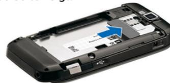
4. Setzen Sie den Akku ein. Richten Sie die Kontakte des Akkus mit den entsprechenden Anschlüssen im Akkufach aus und legen Sie den Akku in Pfeilrichtung ein.
