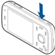
Verwenden Sie zum Vergrößern oder Verkleinern während der Aufnahme eines Bildes die Zoom-Taste am Gerät.
