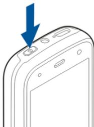
Drücken Sie zum Ausschalten des Geräts kurz die Ein-/Aus-Taste und wählen Sie **Abschalten**.
