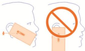
Für eine optimale Rauschunterdrückung halten Sie das Mobiltelefon mit dem Hörer ans Ohr und dem Hauptmikrofon an den Mund. Decken Sie das zweite Mikrofon neben dem Kamerablitz nicht ab.
