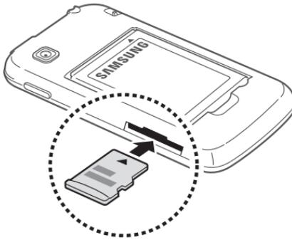
3 Schieben Sie die Speicherkarte in den Speicherkarteneinschub, bis sie einrastet.
