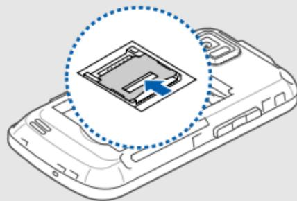
3. Heben Sie die Speicherkartenabdeckung an und legen Sie die Speicherkarte mit der Etikettenseite nach oben ein.
