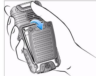
3. Legen Sie den Akku bündig in das Akkufach ein, sodass die drei Metallkontakte oben am Akku an den Metallkontakten im Akkufach anliegen.
