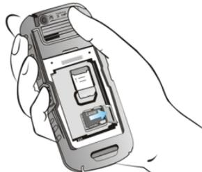
5. Setzen Sie den Akku und die Abdeckung wieder ein. Drehen Sie die Schrauben der Akkuabdeckung im Uhrzeigersinn, um diese zu verriegeln.
