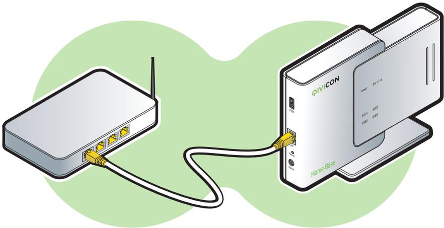
2. Stecken Sie zuerst das Netzkabel in das Netzteil. Schließen Sie dann Ihre QIVICON Home Base an das Stromnetz an.
